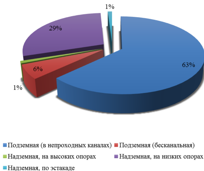
Рисунок 3.4.1-1 - Доля протяженности т/с ООО «Златсеть» в зависимости от типа прокладки
